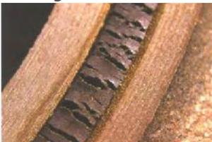
Los elastómeros o juntas tóricas de goma en un amortiguador de stock elastomérico se desgastan después de un tiempo. El caucho se secará y partirá. En algunos casos, el caucho en sí funciona fuera del amortiguador causando una oscilación visible al girar.
